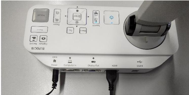
Abbildung 5 - HDMI-Anschluss an der Dokumentenkamera
