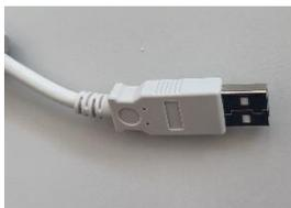
Abbildung 11 u. 12 - USB-A-Anschluss für das mobile Endgerät
