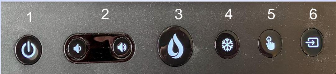
1 Mit dem Power-Knopf startet die digitale Tafel. Durch längeres Drücken kann die Tafel heruntergefahren werden. Durch ein kurzes Drücken wird die Tafel aus dem Stand-By-Modus aufgeweckt.
